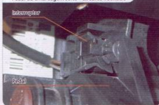
Pedal da embreagem solto - circuito fechado
