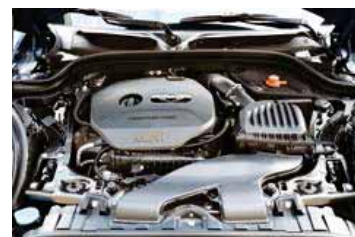
136 Bajuwaren-Pferde im Dreizylinder aus 1,5 Litern (o.), 63 British Racing Horses zerren am 1,3-Benziner (u.)
