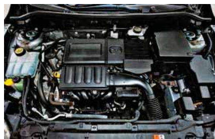
Sehr zuverlässig, aber durchzugsschwach: der Basis-Benziner mit wartungsfreier Steuerkette
