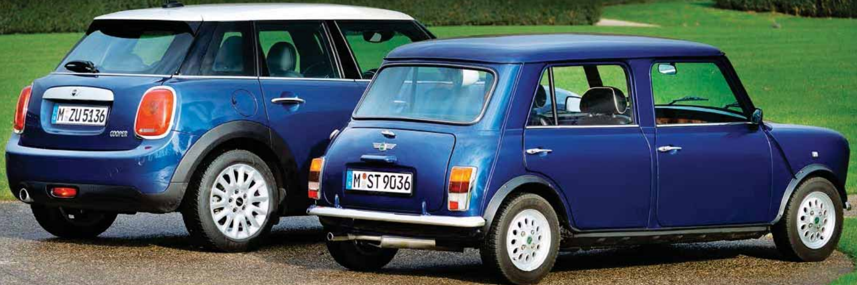
136 Bajuwaren-Pferde im Dreizylinder aus 1,5 Litern (o.), 63 British Racing Horses zerren am 1,3-Benziner (u.)
