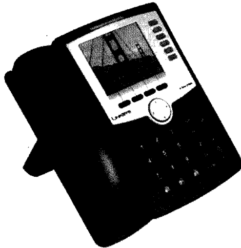
Figura IV-18. Teléfono IP modelo Linksys SPA962, con funciones avanzadas y pantalla a color
